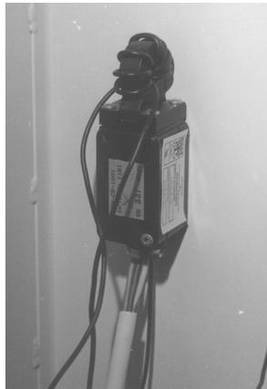
Figura 1 – Sensor de corrente conectado a alimentação do eixo árvore.
